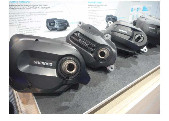
Les moteurs modernes possèdent trois capteurs qui mesurent plus de 1000 fois par seconde la puissance, la fréquence de pédalage ainsi que la vitesse afin d'assurer une parfaite harmonie entre la puissance développée par le cycliste et l'assistance fournie.
